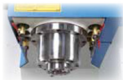
Eixo-árvore com rotação de 8.000 rpm Cone BT-40
